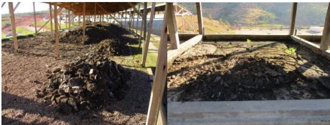
Photo 17 : Zone de conditionnement – Boue séchée après 90 jours sur le lit
