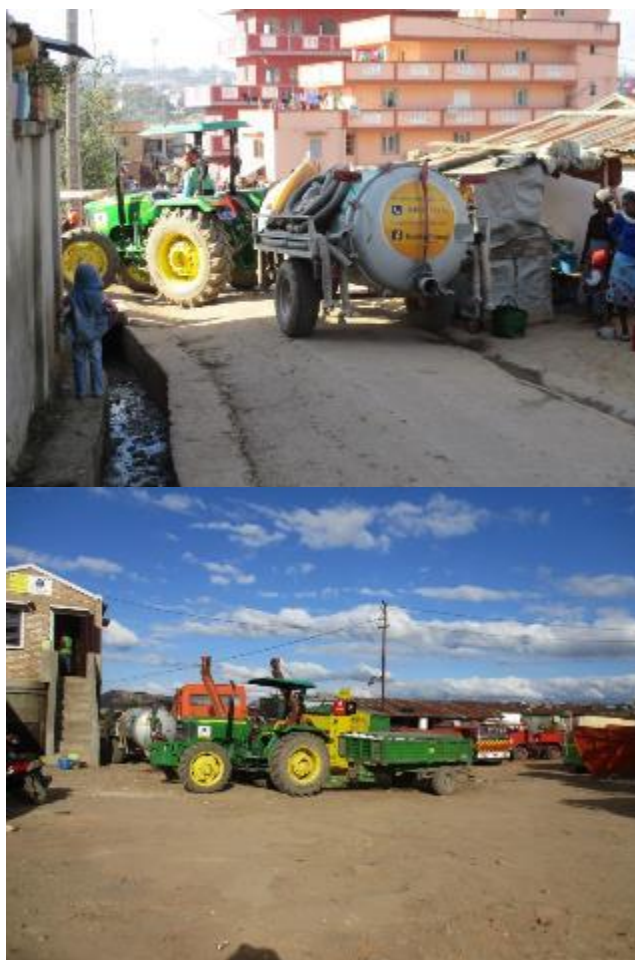
Photo 12 : Tracteur et citerne transportant la boue de vidange vers le site de traitement – Tracteur avec remorque remplie de fûts en plastique
